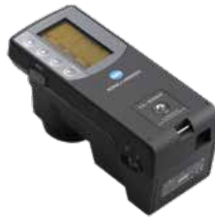
図2：360～780nm 分光照度計 (R26、340円/h)
