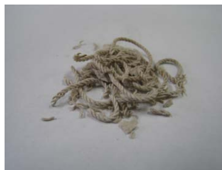
図 4 昇温後すぐ冷却サンプル（反応時間：0 h）
