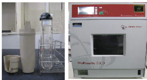
(A)圧力分解容器(石英製) (B)マイクロウェーブ分解装置本体 (Multiwave3000)
