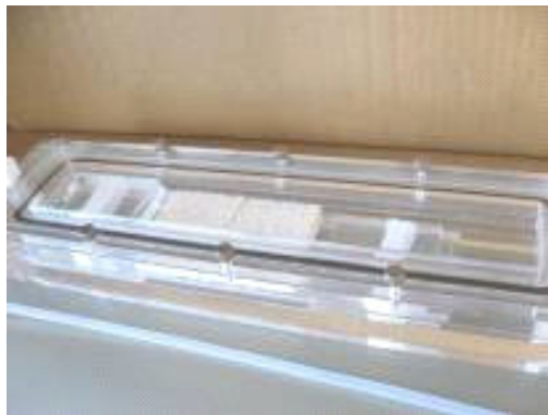
図2 流通型反応容器
