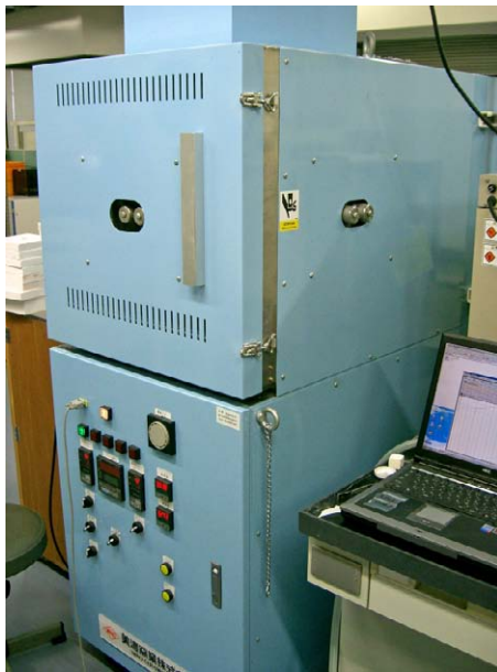
図1 (上 写真) 使用したマイクロ波帯焼結装置 (MW-Master : 美濃窯業(株)製)
