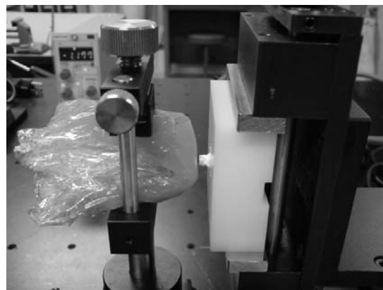
図2 ささみ肉を用いた硬さ測定
