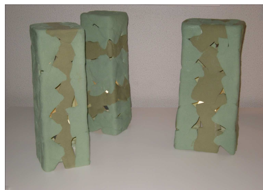
図11 合板製の型にタタラを貼り付けて成形
