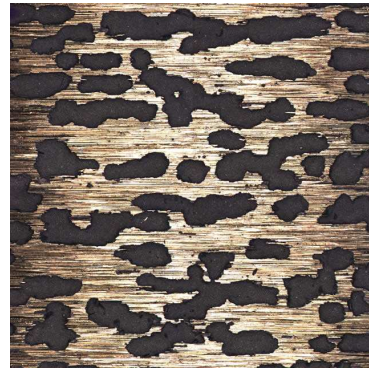
図5 電気分解によって発生した多孔質組織 (ブラスト処理なし)
