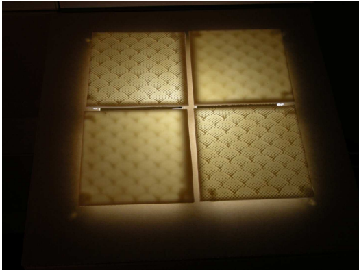
図2 感光性樹脂を用いた網点の凹凸による加飾
