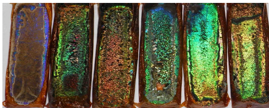
図9. PSの配合比による作成結果 (左からNo. 1~6)
