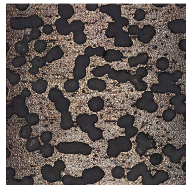
図6 電気分解によって発生した多孔質組織 (ブラスト処理 2 分間)
