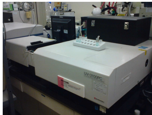
図7. 吸光度スペクトルの測定風景
