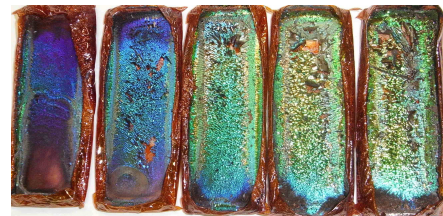
図10. SiO 2 の配合比による作成結果 (左からNo. 1~5)
