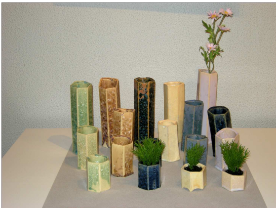
図 13 亜鉛結晶釉を立面に使用
