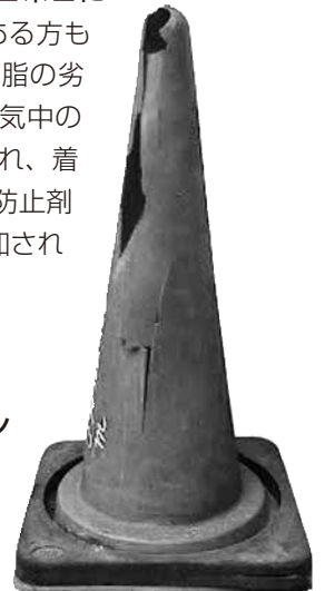
劣化して割れた三角コーン
