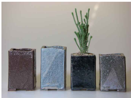
▲今回使用した原料 左から) 砕石脱水粉末、長石洗浄脱水粉末 砕石集塵粉末、パラス洗浄脱水粉末
